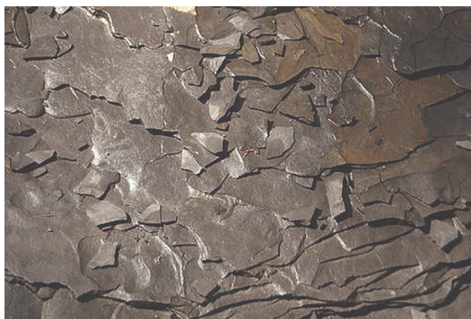
Skalie verdeel maklik in dun teëls wat vir vloere en dakke gebruik kan word. 13
