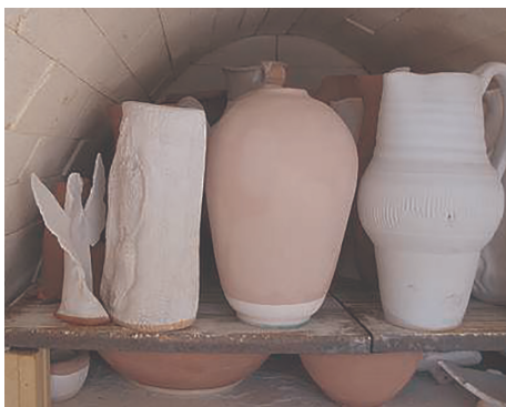
Hierdie kleipotte is uitgedroog en hulle is nou-net in 'n oond geplaas om verhit te word. 3
