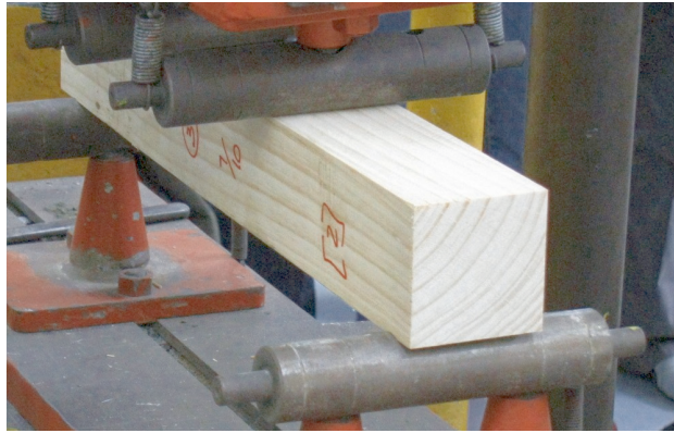
Figuur 5.25 Afskuiwing in hierdie stuk hout het waarskynlik begin toe die vesels aan die onderkant van die balk in spanning gefaal het.
