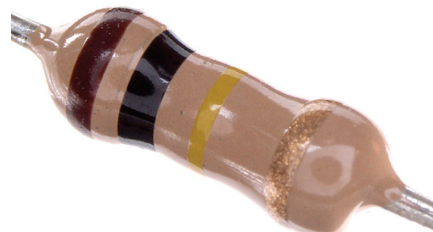
Figuur 14.4b Die kleurbande is bruin, swart en geel, met 'n goudkleurige band aan die einde.
