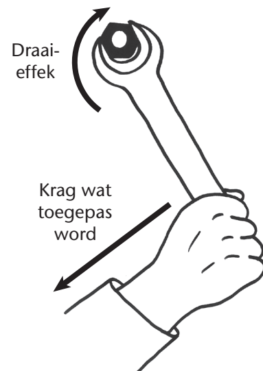
Figuur 4.2 Die krag van die hand het 'n draaieffek rondom die bout.
