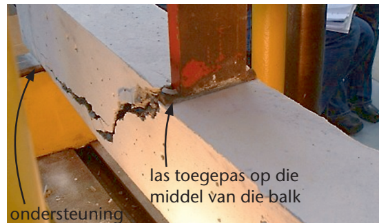
Figuur 5.24 Skuifkrake in 'n betonbalk – hulle begin by die steunpunt.
