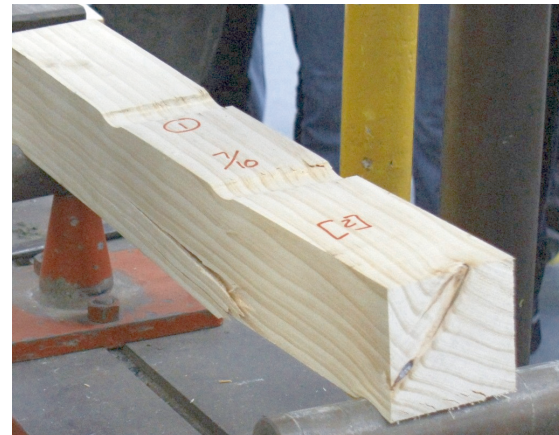
Figuur 5.31b Die vierkantprofiel-houtbalk toon faling in spanning aan die onderkant, klowing as gevolg van kompressie aan die bokant en skuifvlakke in die middel.
