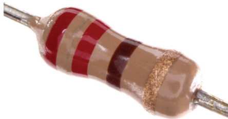
Figuur 14.4a Die kleurbande is rooi, rooi en bruin, met 'n goudkleurige band aan die einde.
